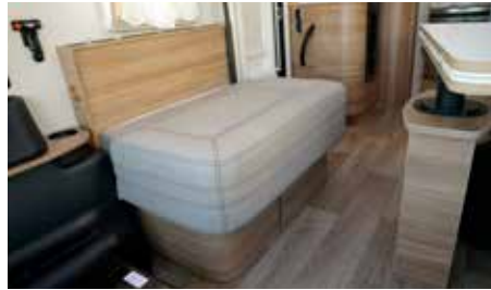
Entfernen Sie die Sitzfläche der Bank, indem Sie die Befestigungen lösen und die beiden Führungsachsen nach oben herausziehen
