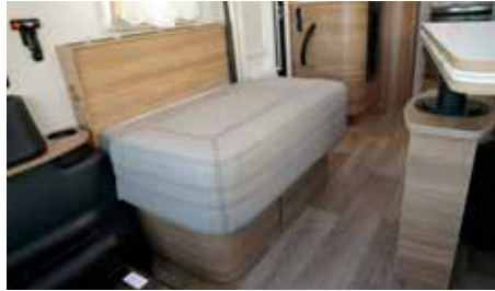
Retirer l'assise de la banquette en libérant la tringlerie et en sortant les 2 axes de guidage vers le haut
