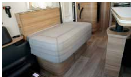
Ta bort sittbänkens säte genom att lossa länken och föra de två styrstiften uppåt
