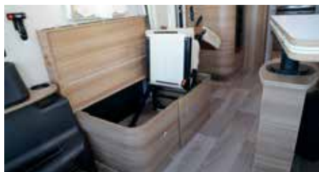
Fjern seteputen fra benkesetet ved å frigjøre de to stagene og ved å trekke de to føringsboltene oppover
