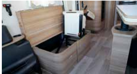
Retirer l'assise de la banquette en libérant la tringlerie et en sortant les 2 axes de guidage vers le haut
