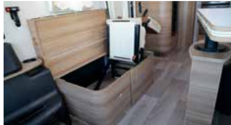
Entfernen Sie die Sitzfläche der Bank, indem Sie die Befestigungen lösen und die beiden Führungsachsen nach oben herausziehen
