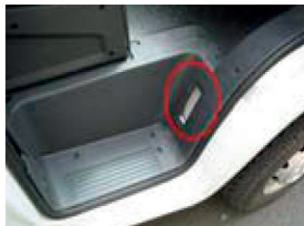
numéro de châssis se situe sur le passage de roue avant droit et au niveau du pare-brise
